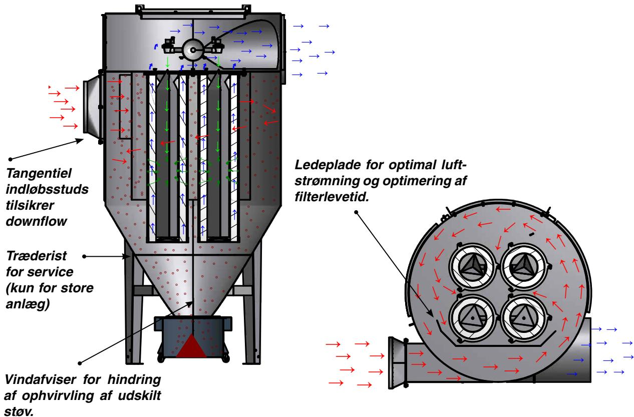
Principskitse for flow gennem cyklonfilter type ACF-T:
